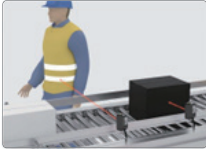
检测物体通过，产线附近的作业员也不会被误检
